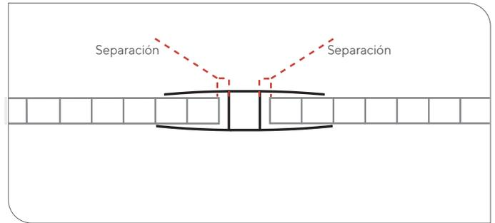
• Dejar separación entre las planchas y perfil H para permitir la dilatación del policarbonato.
