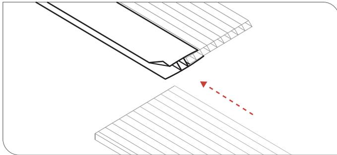
• Abrir un extremo del perfil e introducir a presión un extremo del policarbonato y deslizarlo a lo largo del perfil.
