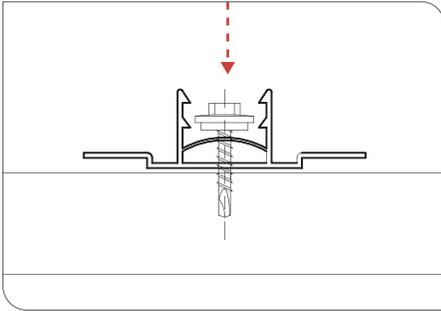
• Fijar la parte inferior del perfil H Clip a la estructura de soporte.
