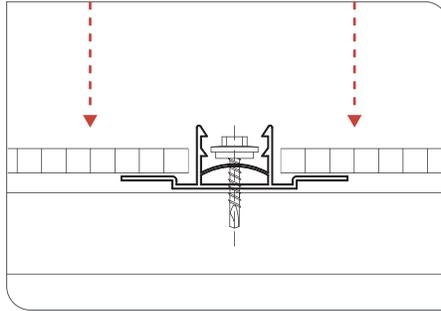
• Colocar las planchas con los alvéolos en el sentido de la pendiente y filtro UV hacia el exterior.
